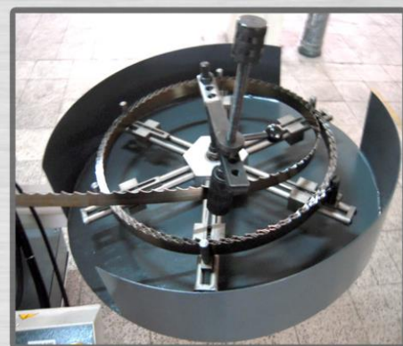
Опциональная система намотки/размотки пилы
