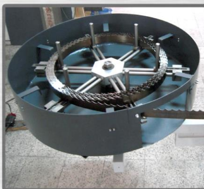
Опциональная система намотки/размотки пилы
